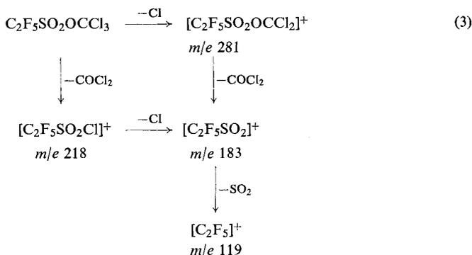
Das Nichtauftreten des Molekül-Ions ist typisch für perchlorierte Kohlenstoffverbindungen.
